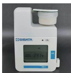
2.将带有传感器的样品容器插入主机中（测定会自动开始）。
